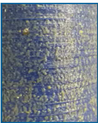
Fig. 1: Ensuciamiento interno del medio filtrante
